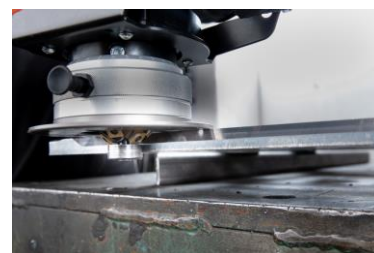
Letörések készítése hegesztést megelőző eljárásoknál
